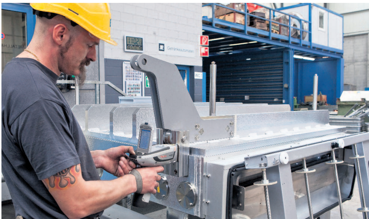
Röntgenfluoreszenzanalyse: Mit einem Hightech-Gerät lässt sich die Legierung dieser Anlage exakt bestimmen.
